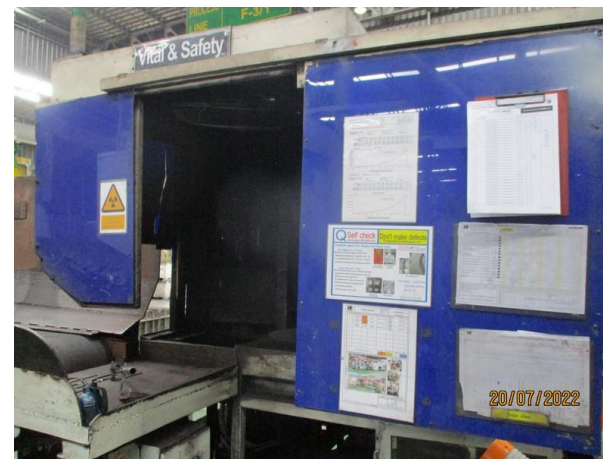
รูปที่ 2-46 การติดตั้ง Photo sensor เพื่อป้องกันเครื่องจักรหนีบ/กระแทก เกิดอันตรายกับพนักงานทำงานกับเครื่องตรวจสอบรอยร้าว
