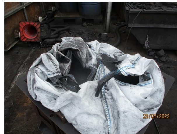
ฝุ่นจากระบบบำบัดมลพิษทางอากาศแบบ Cyclone
