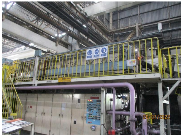
รูปที่ 2-30 แยกพื้นที่ระหว่างพนักงานและเครื่องให้ความร้อนเหล็กท่อน โดยติดตั้งเครื่องจักรบนชั้นลอย
