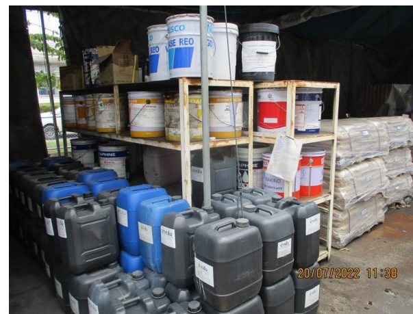
รูปที่ 2-49 การจัดเก็บสารเคมีไว้ในอาคารที่มีหลังคาปกคลุม เพื่อป้องกันการรั่วไหลลงสู่รางระบายน้ำฝน
