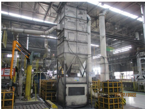
รูปที่ 2-39 Big bag เพื่อรองรับฝุ่นละอองจากการเคาะฝุ่นออกเป็นจิ้งหะของระบบถุงกรองของ เครื่องขัดผิวชิ้นงาน และมีตัวปิดมิดชิด
